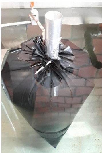
Figura 7. Ensaio de Determinação da Capacidade Volumétrica.
