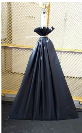
Figura 5. Ensaio de Verificação da Estanqueidade.
