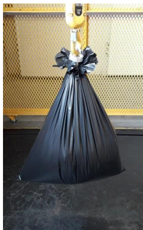
Figura 3. Ensaio de Resistência ao Levantamento.
