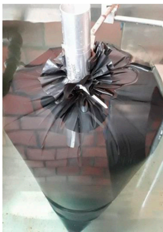
Figura 7. Ensaio de Determinação da Capacidade Volumétrica.
