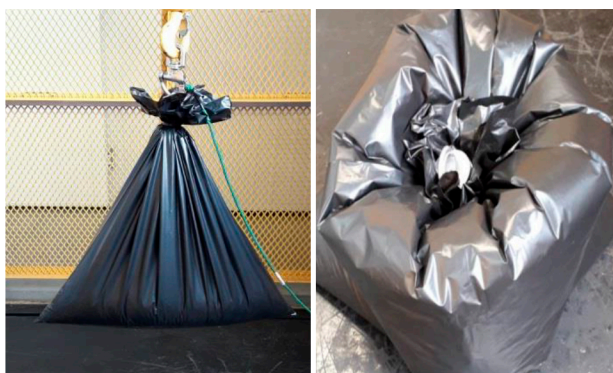
Figura 4. Ensaio de Resistência à Queda Livre.
