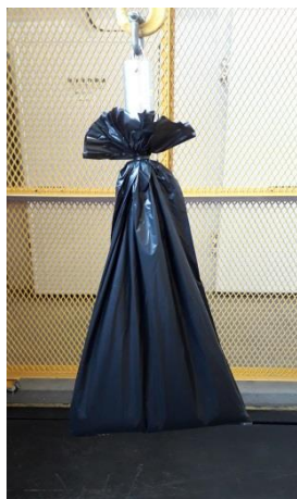
Figura 5. Ensaio de Verificação da Estanqueidade.
