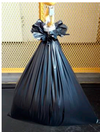
Figura 3. Ensaio de Resistência ao Levantamento.
