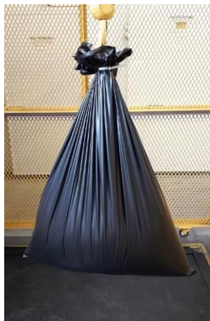
Figura 3. Ensaio de Resistência ao Levantamento.
