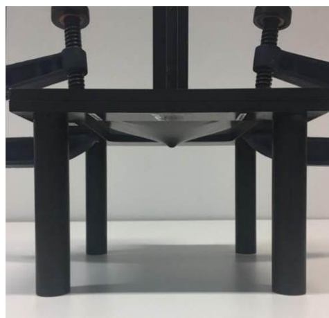
Figura 6. Ensaio de Resistência à Perfuração Estática.
