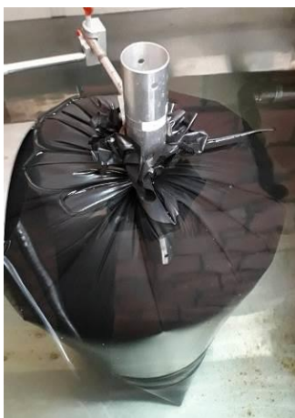
Figura 7. Ensaio de Capacidade Volumétrica.
