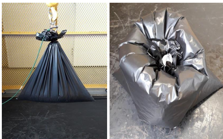
Figura 4. Ensaio de Resistência à Queda Livre.
